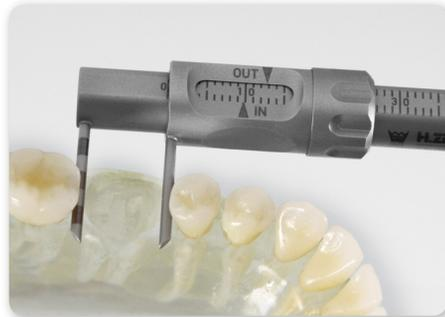
**OUT** zeigt den Außenabstand der Messdorne ( $\varnothing$  1,5 mm) an, **IN** den Innenabstand.
