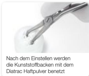
Nach dem Einstellen werden die Kunststoffbacken mit dem Diatrac Haftpulver benetzt
