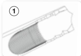
Der Wellenschliff krallt sich radial in die Zahnkronenoberfläche und verhindert eine reitende Bewegung zwischen Zahnkrone und Zangenmaul.
