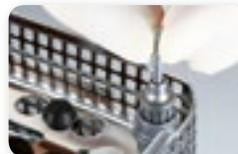
Neben den Ablageeinlässen für zwei RA-Hex-Adapter befindet sich eine Hilfsbuchse für eine komfortable Entnahme der Schraubendreher-Einsätze aus dem RA-Hex-Adapter.
