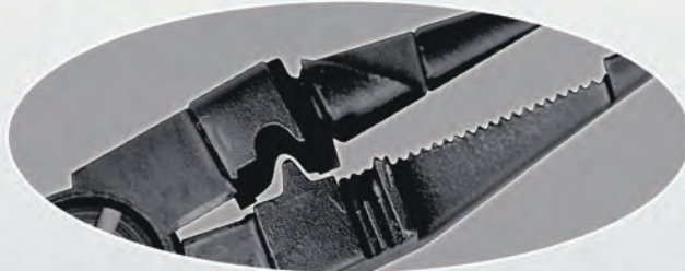
Biegen des Labialaußenbogens Bending of labial outer bows
