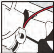
U-Bügel-Draht in Bohrung festklemmen und abwinkeln für rechten und linken Schenkel bei leicht geöffneter Zange Bending U-shaped body wire
