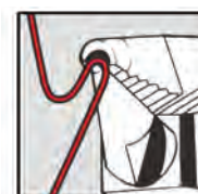
Biegen kleiner Ösen in Kehlbiegeform und Fingerfederchen Bending small eyelets
